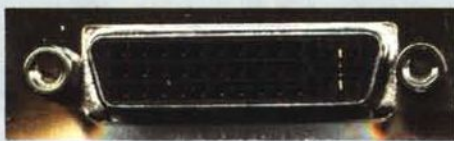
Il connettore da 30 poli P&D; troppo costoso e con funzionalità aggiunte (connessioni USB e Firewire) relativamente inutili, considerando anche il singolo link che ne limita la risoluzione a 1280 x 1024 pixel.
